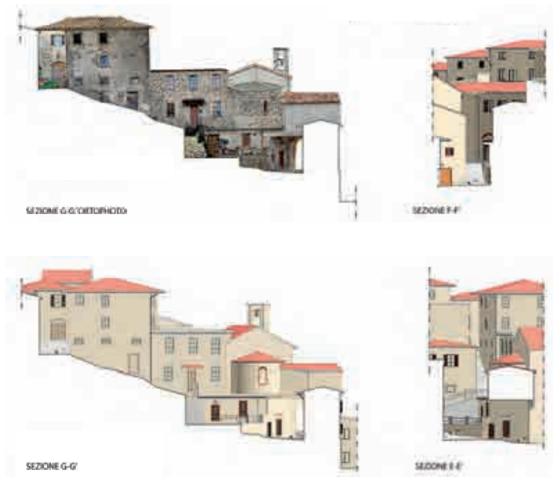
Fig. 14.6 – Rilievo del borgo di Lierna. Restituzioni 2D da modello parametrico HBIM. (Archivio Autore)
