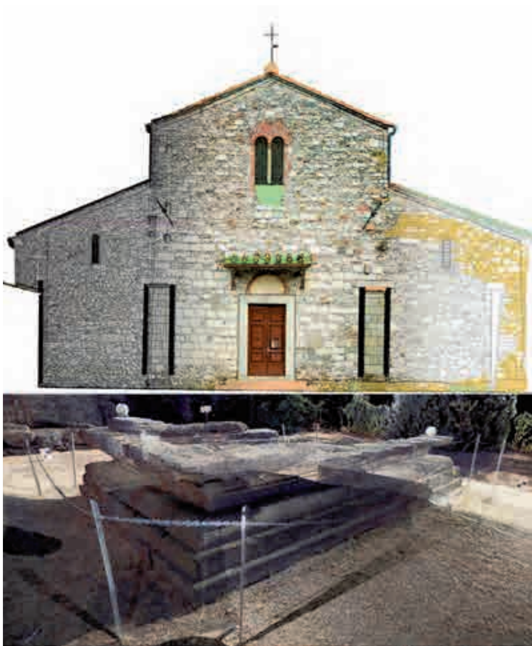
Fig. 14.1 – Pieve a Socana. Sopra . Un prospetto con la scalatura delle descrizioni tematiche. Sotto . La nuvola di punti dell'ara etrusca. (Archivio Autore)
