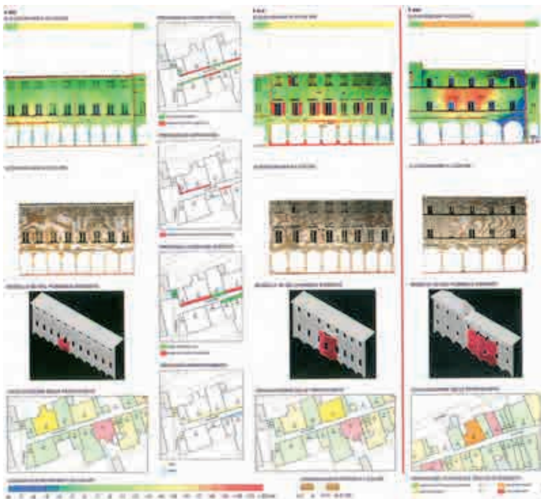
Fig. 14.5 – Rilievo del centro storico di Poppi. Analisi delle deformazioni dei fronti con alcune valutazioni dei ribaltamenti. (Archivio Autore)
