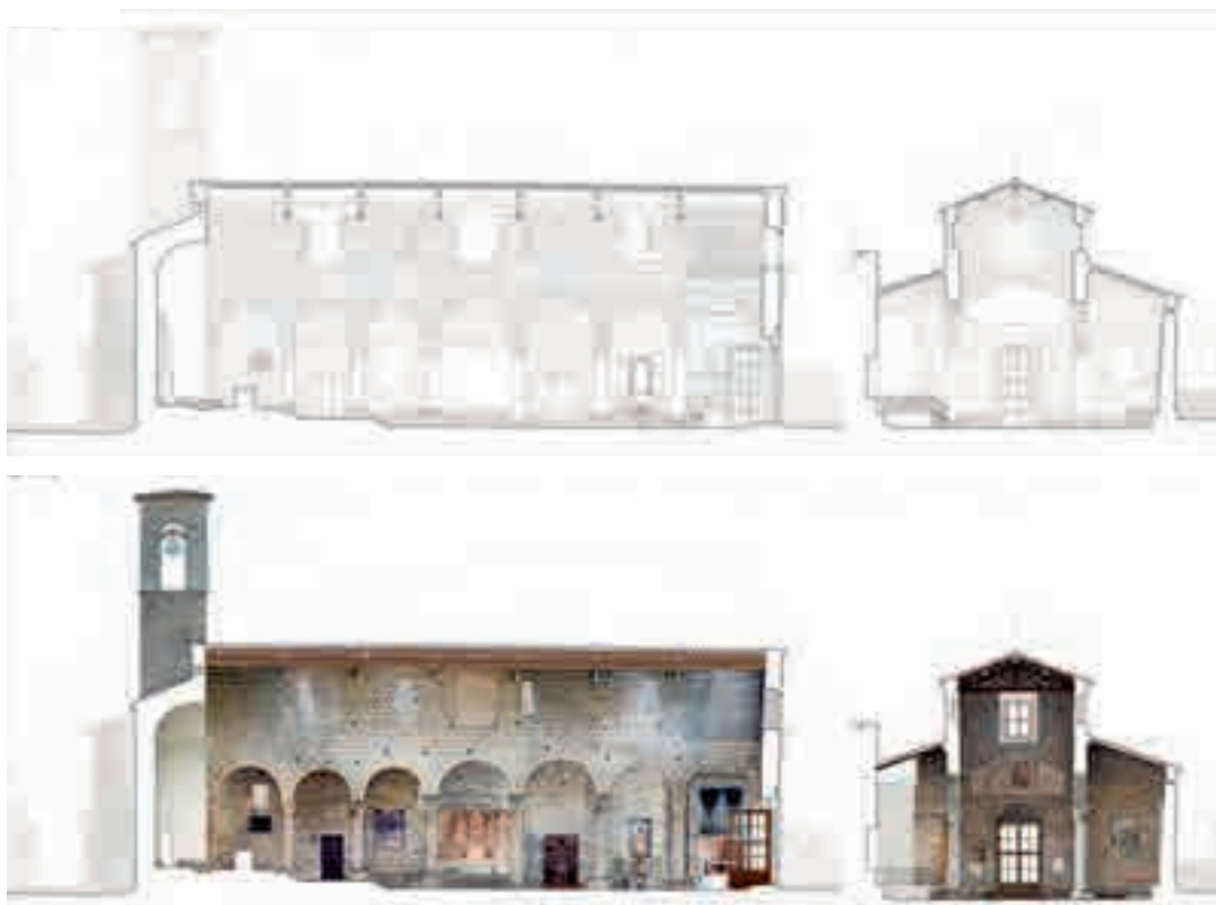
Fig. 14.4 – Rappresentazione del rilievo della Pieve di San Martino a Vado. Sezione longitudinale e trasversale al filo di ferro ( in alto ) e fotopiano ( in basso ). (Archivio Autore)
