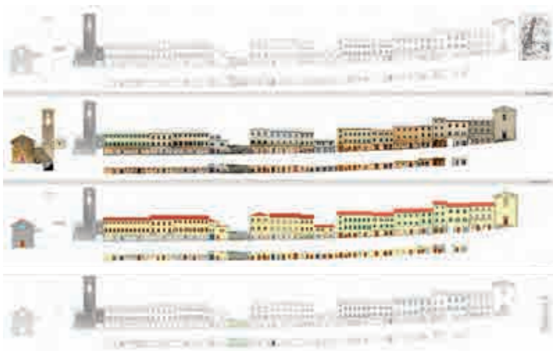
Fig. 14.3 – Rappresentazione del rilievo del centro antico di Poppi. Prospetto di via Dante, nelle diverse variazioni tematiche. Dall'alto in basso. Fil di ferro, fotopiano, analisi dei materiali e analisi del degrado. (Archivio Autore)
